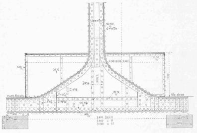
Fig. 20. – Colonne sur escalier. – Elévation
