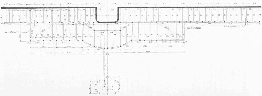
Fig. 6. - Plan du quai, de l'estacade et des glacis. - 1: 500.
