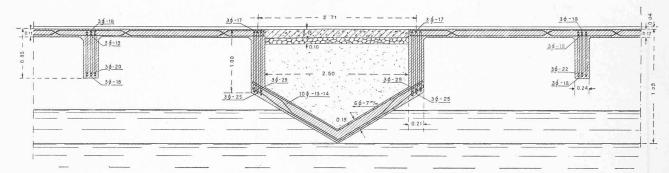
Fig. 7. — Coupe en travers sur cuve à arbre. — 1:60.
