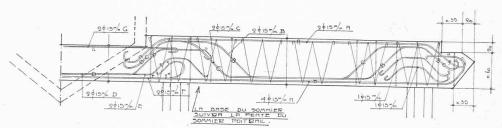
Fig. 11. — Détail des armatures du sommier de renforcement. — 1:60.
