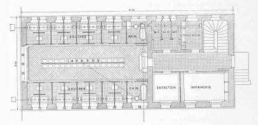
Fig. 73. - Bâtiment de service. - Plan du rez-de-chaussée.
