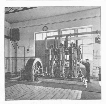
Fig. 70. - Moteur Diesel.
