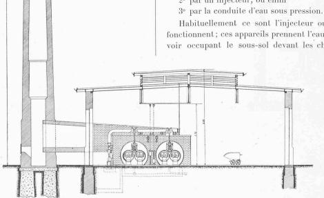
Fig. 72. — Bâtiment central. — Coupe transversale devant les chaudières.
