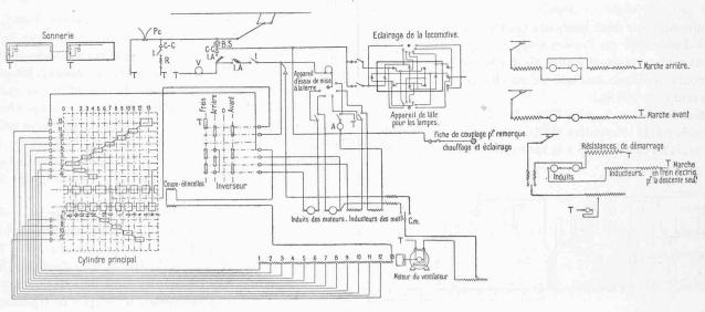
Fig. 21. — Schéma de la distribution de la locomotive.
