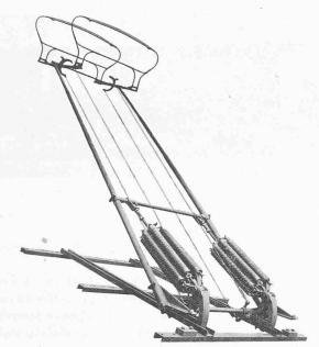
Fig. 20. - Archet de prise de courant.
