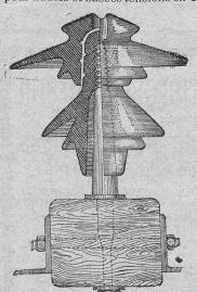
en fer homogène pour Isolateurs
