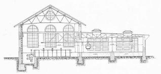
Fig. 60. - Epurateurs. - Coupe transversale.
