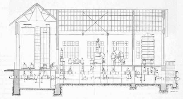
Fig. 56. - Coupe longitudinale du bâtiment des appareils.
