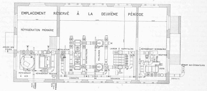
Fig. 57. - Vue en plan du bâtiment des appareils.
