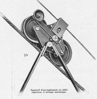
de l'appareil d'accouplement, sans endommager aucunement le câble et sans se détériorer lui-même par l'usage, ne doit souffrir nullement des intempéries, soit de la pluie, de la neige ou de la formation des glaces.
