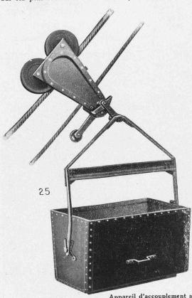
Appareil d'accouplement au câble inférieur, à serrage par la gravité.
