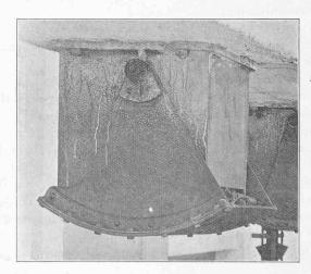
Fig. 47. - Trappe de reprise à coke.
