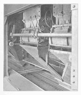
Fig. 53. — Fours. — Tambours de délutage.
