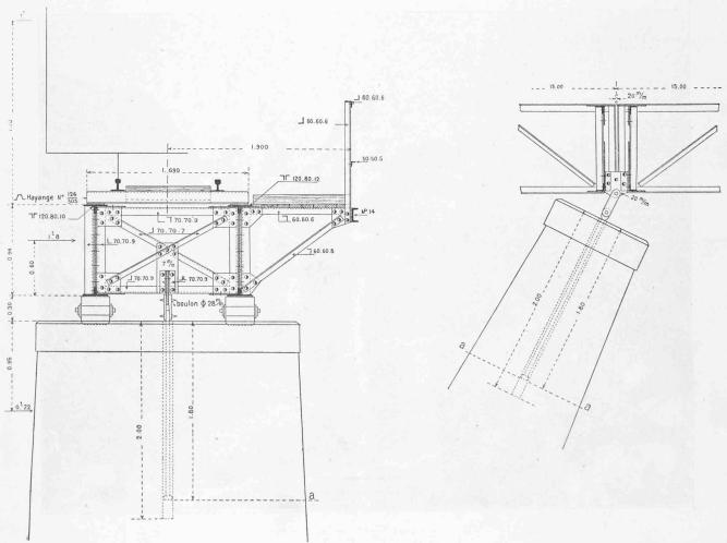
Fig. 7. – Ancrage articulé. – 1:40.
