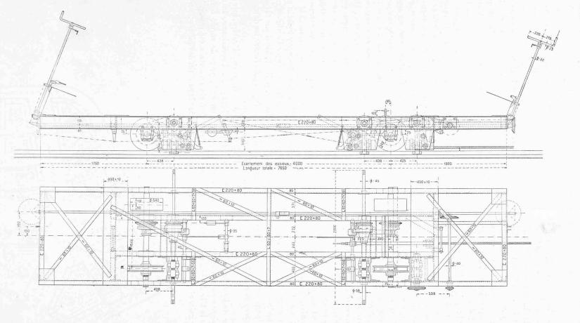
Fig. 13. — Châssis et freins à main et automatique. — 1:40.
