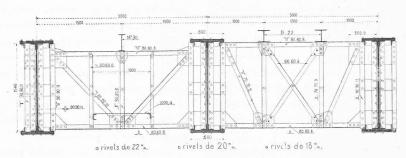
Fig. 6. — Demi-coupe transversale au montant 12-13. — Echelle 1: 60.
