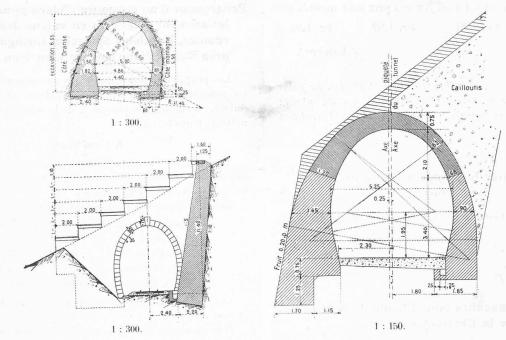
Fig. 19. - Profils renforcés de tunnels.
