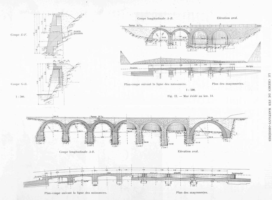
Fig. 14. — Mur évidé au km. 14,6. — Echelle 1: 400.
