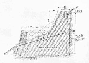
Fig. 21. — Coupe en travers d'une pile. — 1:150.
