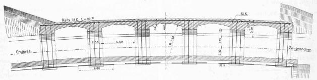
Fig. 20. - Ouvrage d'arrêt de l'éboulement. - 1:300.
