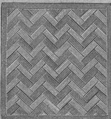
Vissé sur faux ou vieux plancher, rendu posé au bain de mortier de silicate de soude sur béton en ciment Portland, ou béton en scorie,
