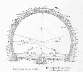
Profil moyen des revêtements en souterrain. MO = maconnerie ordinaire. MOV = maconnerie ordinaire, voûte. MAI = maconnerie appareillée injectée. D = dalle. BO = béton ordinaire. ME = maconnerie et enduit.
