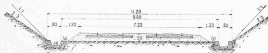
Profil en déblai dans les terrains argileux et humides. Fossés avec revêtement à pierres sèches et au besoin en maçonnerie avec barbacanes et radier en béton.
