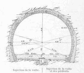
Profil moyen des revêtements en souterrain. MO = maçonnerie ordinaire. MOV = maçonnerie ordinaire, voûte. MAI = maçonnerie appareillée injectée. D = dalle. BO = béton ordinaire: ME = maçonnerie et enduit.
