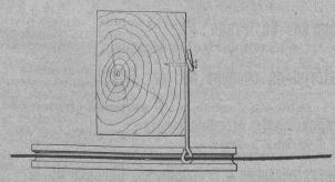
errier et de l'armature. Mode de fixage sous poutrelles en fer. Détail du crochet et de l'armature. Mode de fixage sous solive en bois.
