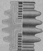
Isolateurs à cannelures pour tensions de 5000 à 60,000 volts.
