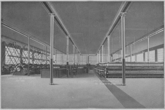
Encombrement minimum des salles « Éclairage meilleur » Circulation non gênée par les courroies, et sécurité absolue contre les accidents.
