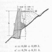
Murs de soutènement en maçonnerie à mortier. -1:300.
