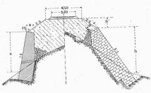
Type d'assise avec enrochement. Mur à mortier avec enrochement. avant-perré.  $a=0.6+0.06~H. \quad x{=}0.4+0.1~h+0.5~h'{\geqslant}0.7.$  Murs sous remblai. -4:300.
