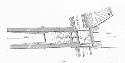
Fig. 8. — Galerie de protection au km. 8,700. Echelle 1 : 400.
