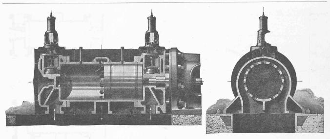
Fig. 1. - Coupe du cylindre d'une machine à flux continu de Sulzer frères.
