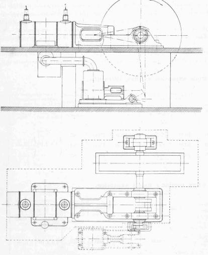
Fig. 11. — Disposition d'une machine à flux continu, type Sulzer.
