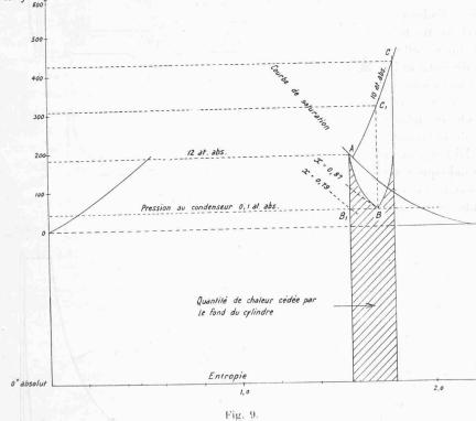
condenseur (fig. 2). Dans les machines ordinaires, la vapeur détendue et humide revient en arrière et refroidit les parois du cylindre, ce qui amène une condensation de la vapeur fraîche lors de l'admission suivante. Dans les machines à « flux continu » rien de semblable : la vapeur fraîche ren-
