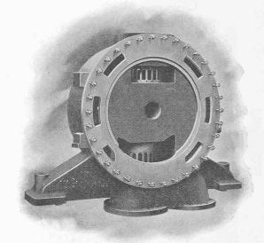
Fig. 2. — Vue d'une tête de cylindre Kerchove avec enveloppe de vapeur.
