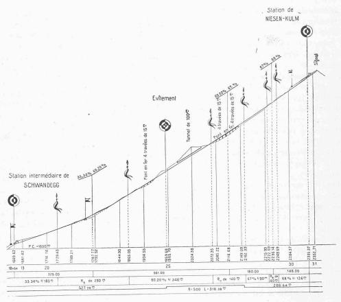
Fig. 3. - Profil en long de la II<sup>o</sup> section.
