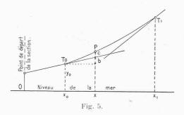
b est la hauteur au-dessus de  $T_o$  de la projection de P sur la tangente initiale.
