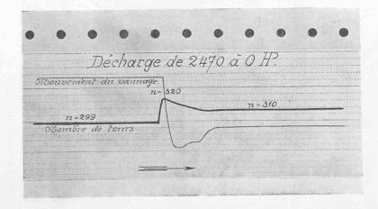
Fig. 17. — Tachogrammes d'essais des turbines Piccard, Pictet & Cio.
