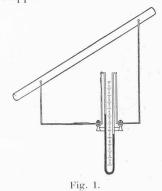
Le manomètre contient du mercure jusqu'à une certaine hauteur; l'une des branches de l'instrument reçoit l'eau sous pression prise en un point et l'autre branche, l'eau prise en un autre point de la conduite. Les tubes de cuivre qui amènent l'eau sous pression aux deux branches du manomètre et le manomètre lui-même doivent être entièrement purgés d'air.
