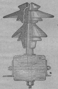
en fer homogène pour Isolateurs
