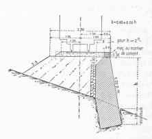
Mur de soutènement à mortier. — 1:150.
