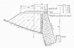
Mur de soutènement à pierres sèches. -1:150.
