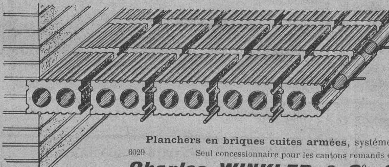
Planchers en briques cuites armées, système Fabre, Brevet 25593 +
