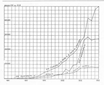
Fig. 1. - Production de la Suisse en machines électriques.
