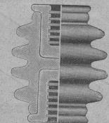
Isolateurs à cannelures pour tensions de 5000 à 60,000 volts.
