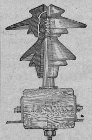
en fer homogène pour Isolateurs
