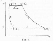
L'air atmosphérique (p, T) est comprimé suivant l'adiabatique A B jusqu'en B où il est à l'état (p', T'). Sur B C a lieu la combustion du pétrole et l'échauffement des gaz sous pression constante, jusqu'en C où ils sont à l'état  $(p', T'_4)$ . De C en D a lieu la détente adiabatique. En D, les gaz sont à l'état  $(p, T_4)$ . En D A a lieu l'échappement sous pression constante. Le long de B C, l'air reçoit par unité de poids la quantité de chaleur
