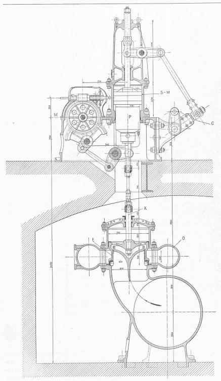
Fig. 8. — Turbine de 3200/3850 HP. de l'usine de la Kander, à Spiez. Ensemble du régulateur et de l'orifice compensatenr. Echelle 1 : 30.
