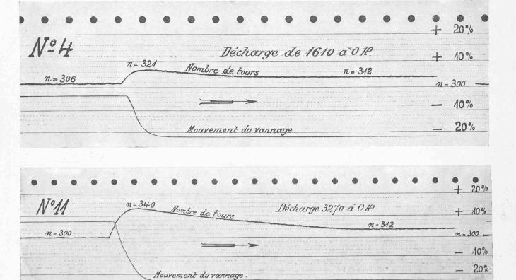
Fig. 6. - Tachogrammes des turbines 3200/3850 HP. de l'usine de Spiez.
