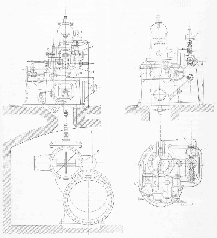
Fig. 7. — Turbine de 3200/3850 HP. de l'usine de la Kander, à Spiez — Ensemble du régulateur et de l'orifice compensateur. Echelle 1:30.
