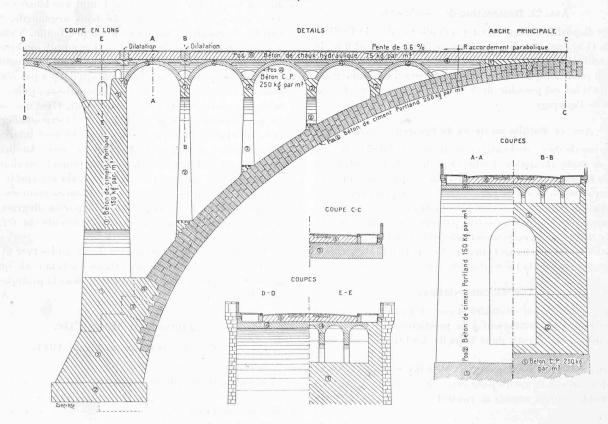
Pos 2, lire 180 kg. par m³ au lieu de 150 kg. Pos 5, lire béton de ciment Portland 250 kg. par m³ avec pierres cassées.
