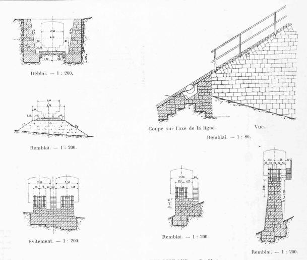
Fig. 3. — LE FUNICULAIRE LES AVANTS-SONLOUP. — Profils-types.
