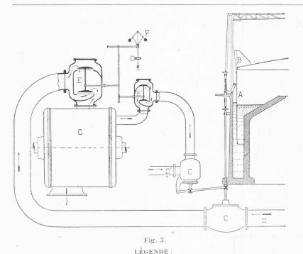
A= Cloche. -B= Came de commande des soupapes automatiques. -C et C= Soupapes à basse et à haute pression. -E et E= Obturateurs automatiques à basse et à haute pression. sion de la turbine. — F = Régulateur tachymétrique. - G = Turbine
