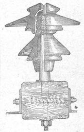
en fer homogène pour Isolateurs
