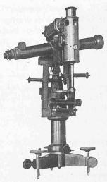
Fig. 24. — Petit instrument d'alignement, du tunnel du Simplon.
