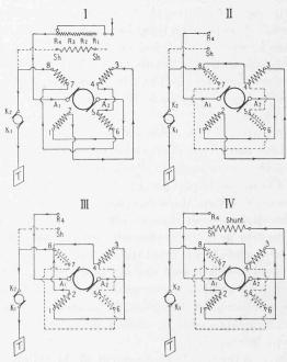
Fig. 7. — Schémas des différentes connexions du moteur de traction.
