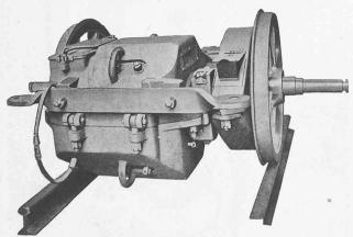
Fig. 6. - Moteur de traction.
