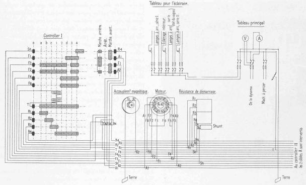
Fig. 5. - Schéma des connexions de la voiture.
