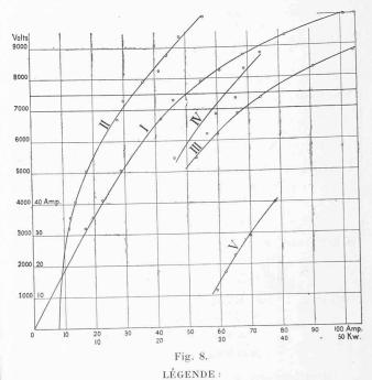
= Caractéristique de marche en moteur synchrone à vide sous courant
