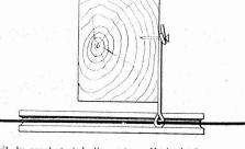
Mode de fixage sous poutrelles en fer. Détail du crochet et de l'armature. Mode de fixage sous solive en bois.
