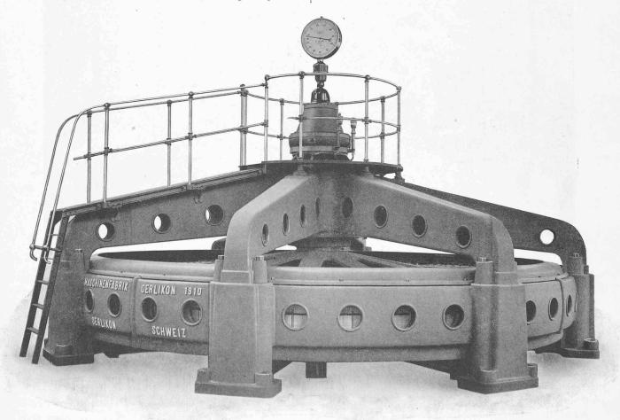
Fig. 5. - Alternateur de 500 K. V. A., 150 pôles, pour Brême.
