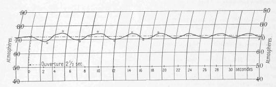
Fig. 7. — Ouverture, en 2,5 secondes, de  $\theta$  à 150 l.-sec.
