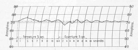
Fig. 11. — Fermeture, en 5 secondes, de 335 l.-sec. à  $\theta$  puis ouverture, en 5 secondes, de  $\theta$  à 335 l.-sec.
