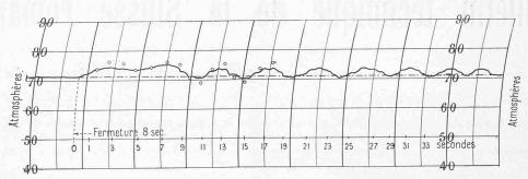
Fig. 5. — Fermeture, en 8 secondes, de 493 l.-sec. à 0.
