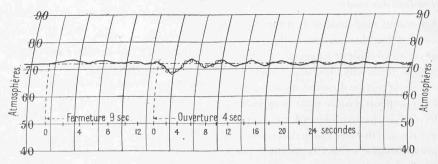
Fig. 8. — Fermeture, en 9 secondes, de 178 l.-sec. à 0 puis ouverture, en 4 secondes, de 0 à 178 l.-sec.
