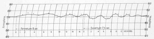
Fig. 9. — Fermeture, en 8 secondes, de 490 l.-sec. à 0, puis ouverture, en 7,5 secondes, de 0 à 493 l.-sec.
