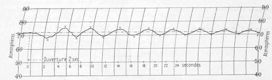
Fig. 6. — Ouverture, en 2 secondes, de  $\theta$  à 150 l.-sec.
