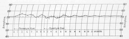
Fig. 10. — Fermeture, en 6 secondes, de 335 l.-sec. à  $\theta$ , puis ouverture, en 6 secondes, de  $\theta$  à 335 l.-sec.
