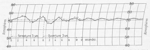
Fig. 12. — Fermeture, en 3 secondes, de 178 l.-sec. à  $\theta$ , puis ouverture, en 3 secondes, de  $\theta$  à 178 l.-sec.
