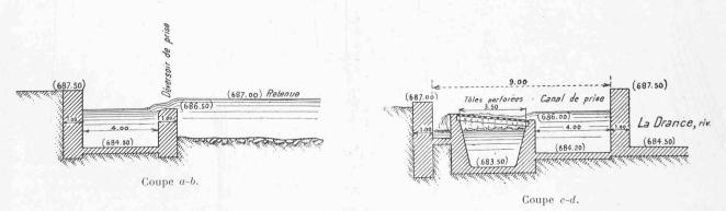
Fig. 4. — Coupes de la prise d'eau. — Echelle 1 : 200.
