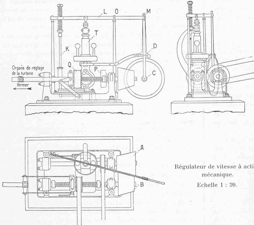
que), mais le chemin que décrit cet axe est réglé par une plaque de guidage *D*. Ce disque est pris entre deux cônes *A* et *B* identiques actionnés l'un, le cône *A*, par le renvoi, l'autre, le cône *B*, par la friction qu'exerce le disque *C* sur lui. Le cône *A* est ajusté sur un arbre sur lequel est fixé la poulie *P* de telle sorte que la poulie, l'arbre et le cône faisant corps, la vitesse du cône *A* sera toujours celle du renvoi.
