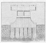
Fig. 8. — Détails de construction des fondations système Compressol. Pont en béton armé sur la dérivation de l'Ourthe, à Liège.
