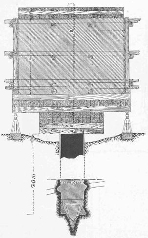
Fig. 6. — Schéma des dispositions de l'expérience de charge directe d'un pylòne.
