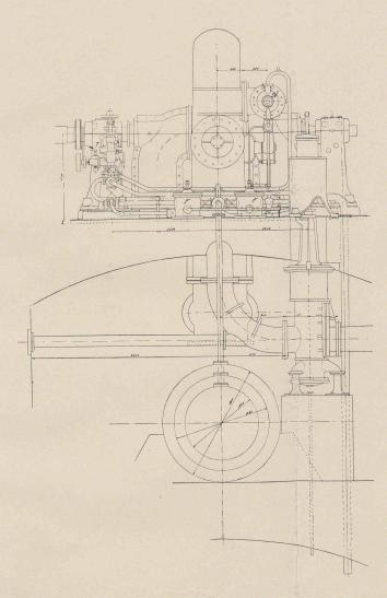
Fig. 29. — Turbine Francis de 2000 chevaux. Plan et élévation. Echelle 4 : 40.
