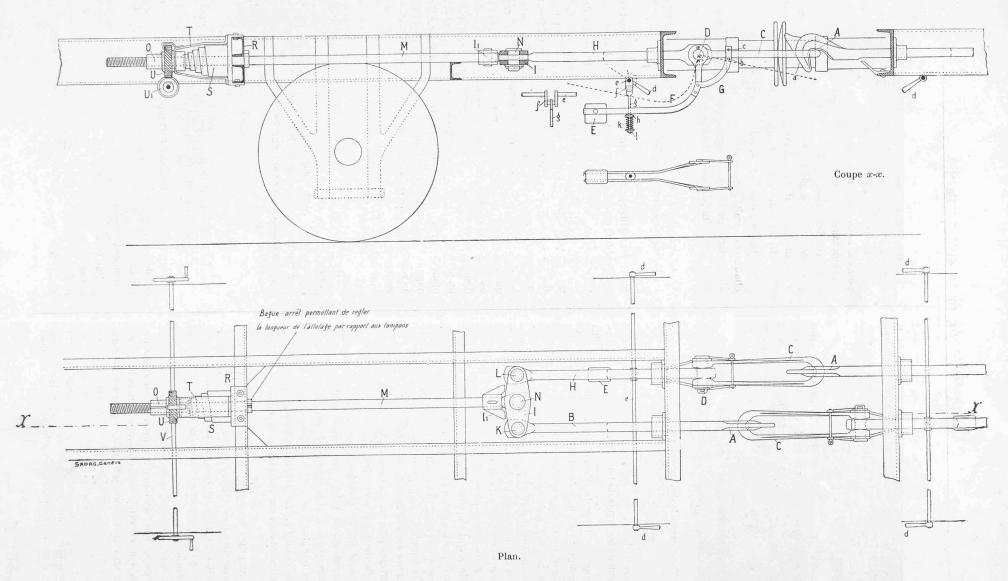
Fig. 1. — Attelage automatique, système Vinzio. — Echelle 1: 20.
