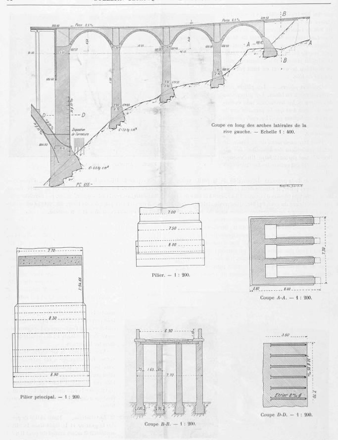
Fig. 11. - Ouvertures latérales. - Pont du Gmündertobel.
