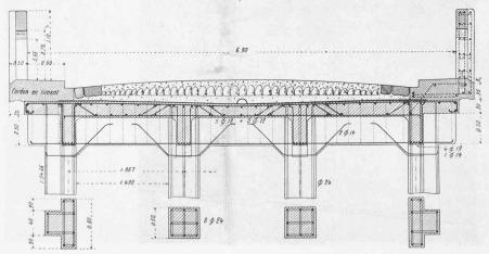
Fig. 8. — Coupe en travers de la chaussée. — 1:60.
