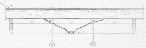
Fig. 8. — Pont-canal des Pontets en ciment armé. — 1 : 200.
