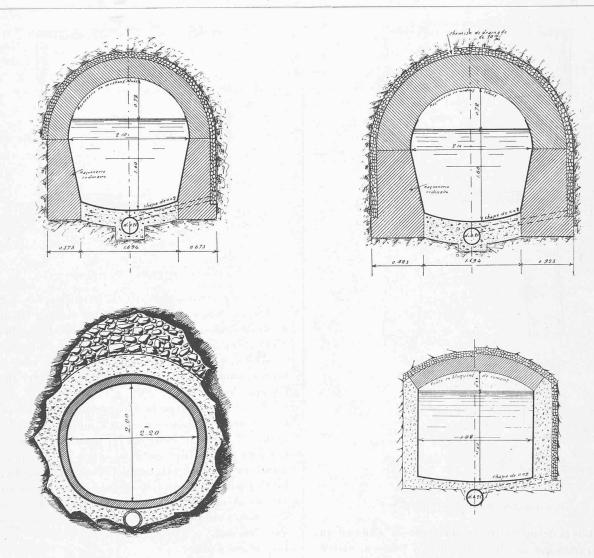
Fig. 7. - Profils-types du tunnel d'amenée.
