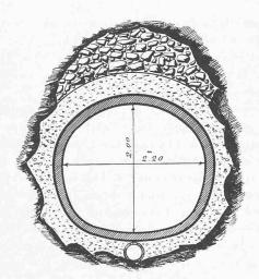
Fig. 10. - Section du tunnel armé.
