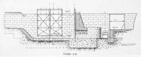
Fig. 3. - Coupes en travers de la prise d'eau. - 1 : 200.
