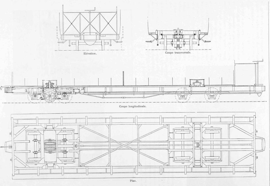
Fig. 21. - Voiture du chemin de fer de Chamonix au Montenvers. - Echelle 1:40.
