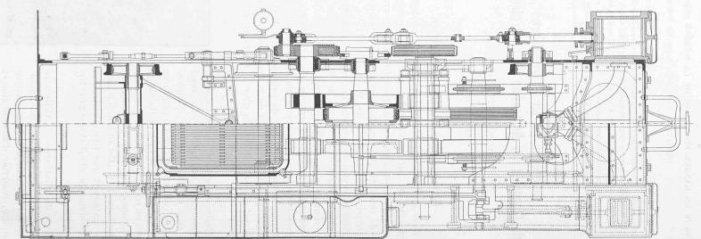
Fig. 18. — Locomotive du chemin de fer de Chamonix au Montenvers. — Echelle 1:30.
