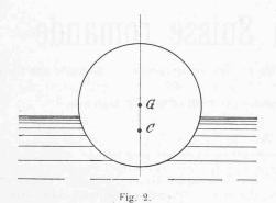
soit la position du corps. C'est le cas, par exemple, d'une sphère homogène (fig. 2).
