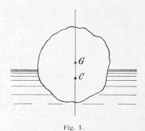
Ce corps peut être en équilibre stable, indifférent ou instable, suivant sa forme et la position qu'il occupe.
