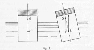
Il n'est pas besoin de démonstration pour voir que le bateau tend à reprendre sa position première lorsque la force qui a produit l'inclinaison cesse d'agir. Le poids du bateau et la poussée de l'eau agissent comme dans le cas de l'équilibre stable, dans le sens du redressement, ce que l'on constate facilement en comparant les figures 3 et 6.
